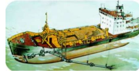
Figure 9 : Atelier de dragage hydraulique - Drague aspiratrice en marche avec son élinde trainante latérale
