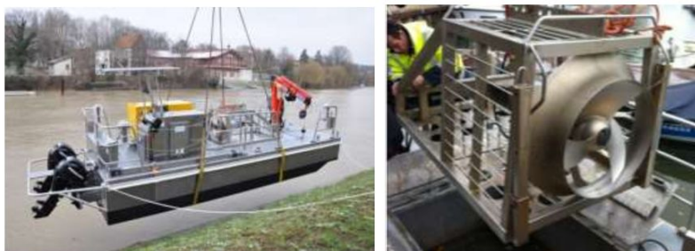
Figure 13 : Barge polyvalente permettant le dragage par remise en suspension)
