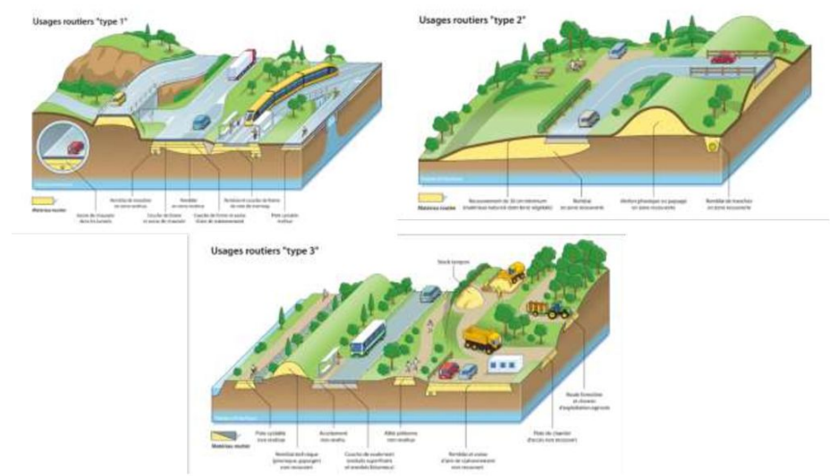
Figure 17 : Usages routiers type 1, 2 et 3 (Source : Cerema)
